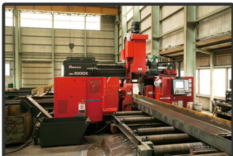
H形鋼孔明加工機
